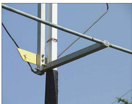
Bild 14: Reflektorbefestigung im am Ende U-förmig aufgeschlitzten Ausleger zur Vermeidung einer Kurzschlusswindung; zur Fixierung dient Heißkleber.
