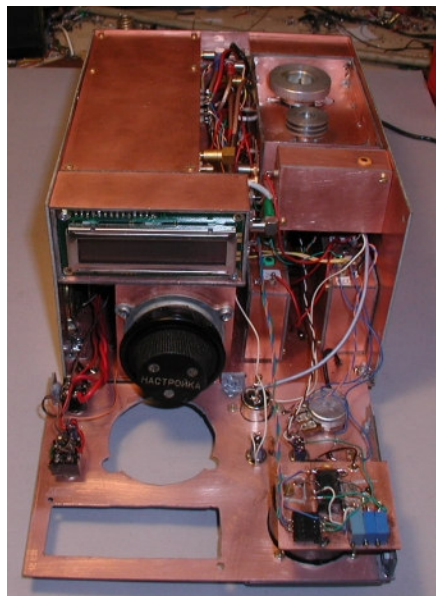
TRANS144 Vista con pannello frontale reclinato a cablaggio finito. In alto a sinistra: MF455tx/rx a destra: l'amplif. di potenza in centro a sin: il frequenzim. con sotto il VFO(VXO) mentre a destra sono visibili: BFO, LO 54.045 e modulo BF/commut. Sul retro dello strumento è montata la basetta trimmer e relè strum.
