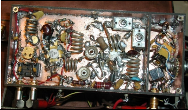
AMPLIFIC. 10 W: da sin a destra: relè+ TR3+ TR2+ bob e comp+ finale TR1 con sopra i 2 comp. di accordo. Dopo lo schermo a destra L1 con coa1 e sotto i relè commut di antenna con BNC
