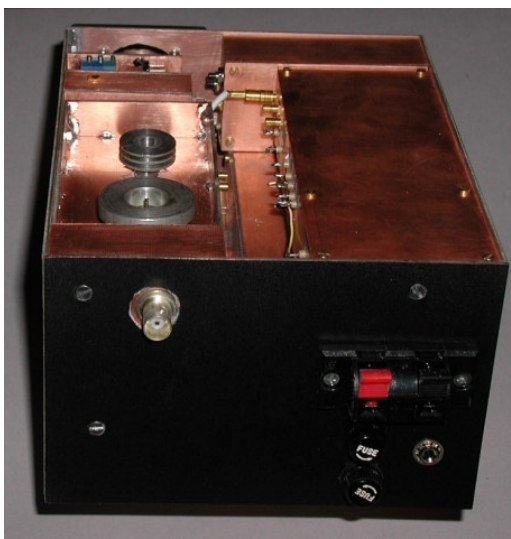
TRANS144 Vista dal retro completo di moduli, prima del cablaggio
