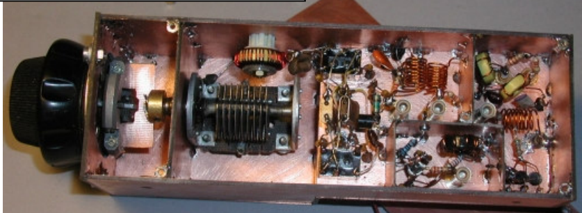
VFO(VXO) – sopra il variabile c'è L1. A fianco i 2 quarzi con i 2 relè bistabili. Notare i vani di schermatura e i compensat. che fanno anche da sostegno. In alto a destra il filtro passa basso con sotto i 3 TR in parallelo
