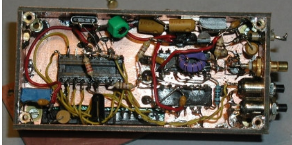
MF455tx/rx + CAG +DBM – A destra i 2 filtri collins con i relè usb/lb. In basso a sin. il dbm TUF1 con l'in BFO schermato.
