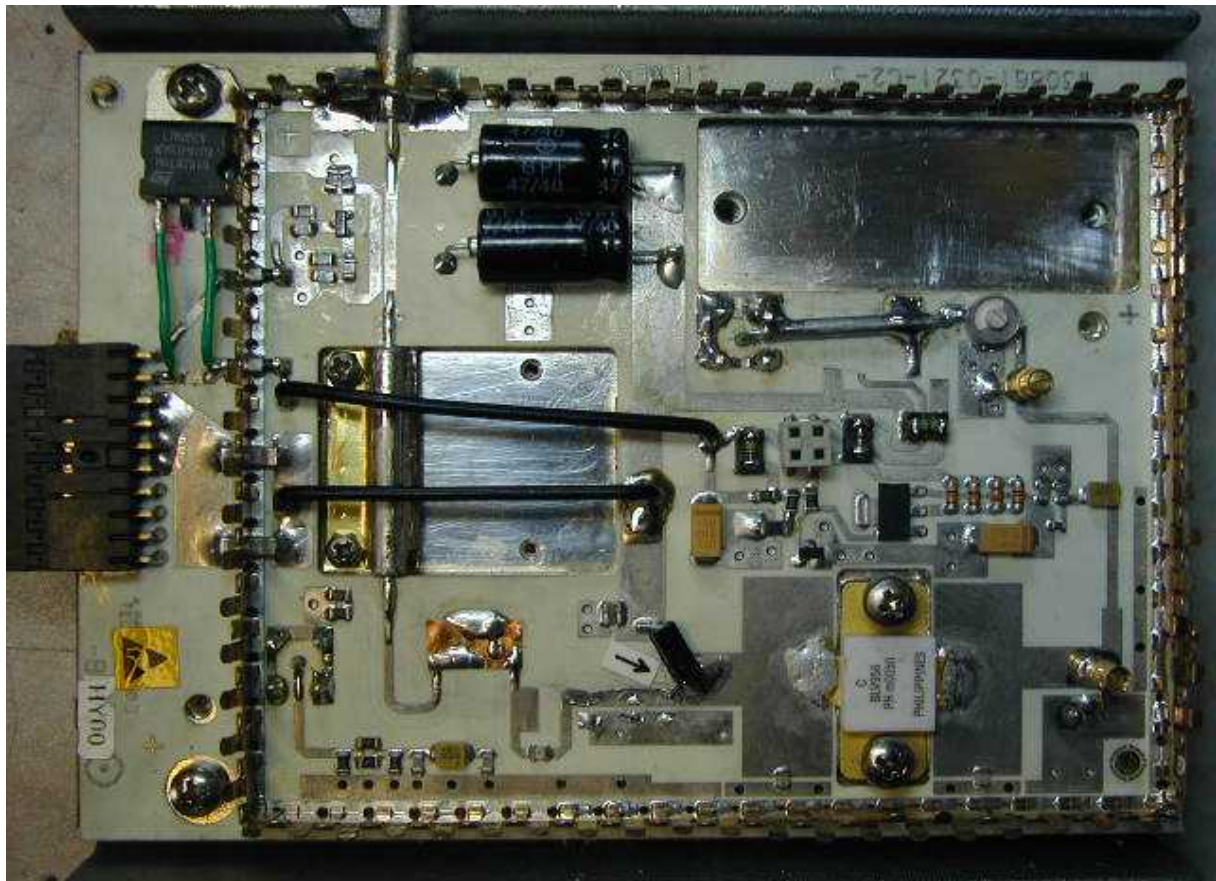
Bild 6 Fertig umgebaute Endstufe optimiert für das 23cm Band
